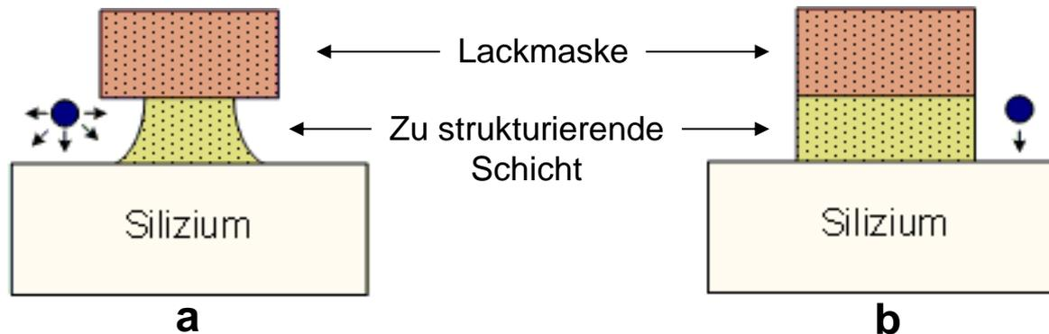
Isotroper (a) und anisotroper (b) Ätzprozess mit einer Maske
